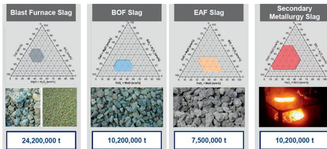
Abb. 6: Schlackentypen und produzierte Mengen in der Europäischen Union. Quelle: REACH EUROFER, EUROSLAG, Worldsteel Association
